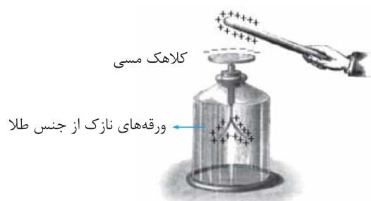
برای تعیین نوع بار یک جسم رسانا باید از یک الکتروسکوپ باردار استفاده کرد. برای باردار کردن الکتروسکوپ مطابق شکل زیر از روش القا استفاده می‌کنیم.
